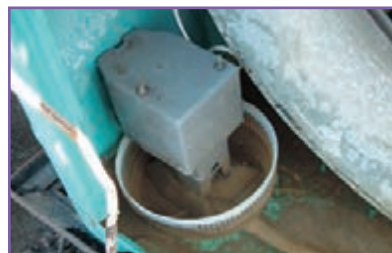
ج- بررسی و تمیز کردن بمپ آب
