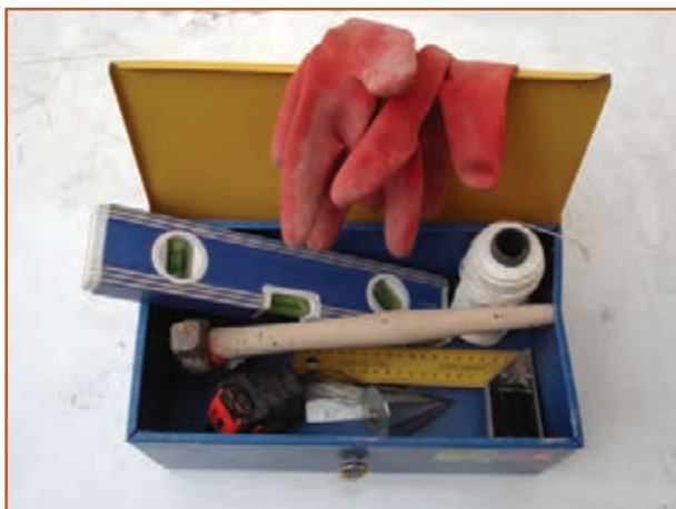
شکل ۱۰-۸- برخی از ابزار مورد نیاز دیوار چینی
