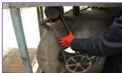
پ- بررسی وضعیت تسمه
