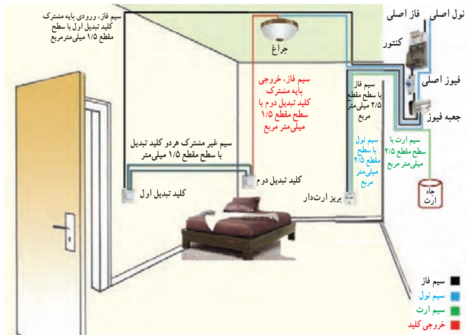
شکل ۱۸-۶ - سیم‌کشی مدار کلید تبدیل
