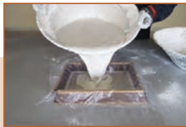
ث - ریختن ملات گچ در قالب
