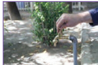
خ - آزمایش آب بندی شیر
